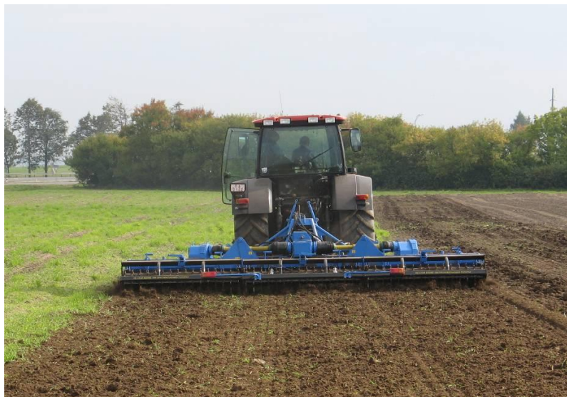
Рисунок 5. – Агрегат комбинированный почвообрабатывающий с активными (роторными) рабочими органами АКП-6 производства РУП «Сморгонский завод оптического станкостроения»
