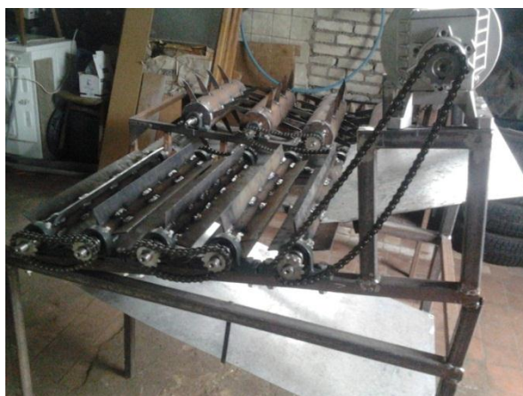
Рисунок 3. – Установка типа роторно-планчатый соломотряс Состав льновороха, поступающего от комбайна, представлен в таблице 1.
