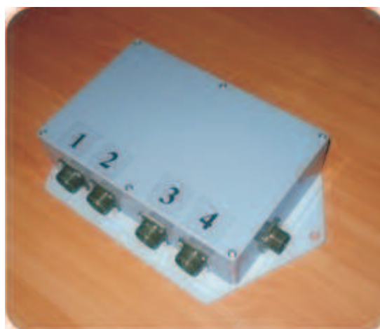
Рис. 4. Контроллер семяпроводов КС (версия 2013 г.).
