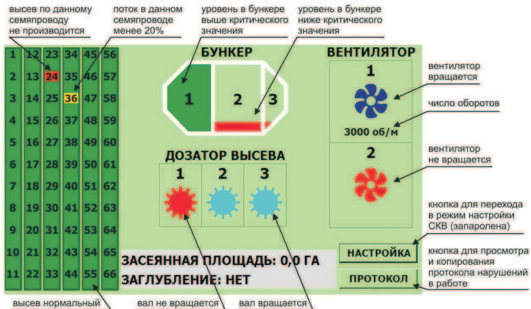
Рис. 2. Передняя панель сенсорного монитора «Премиум» на базе панельного компьютера. Программное обеспечение – ООО «Электронные системы»
