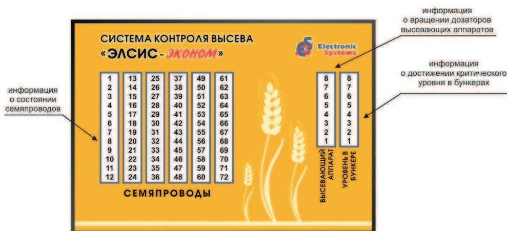
Рис. 1. Передняя панель светодиодного монитора «ЭКОНОМ»
