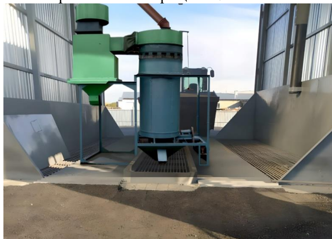
Рисунок 17 – Воздушный центробежно-решетный сепаратор на испытаниях
