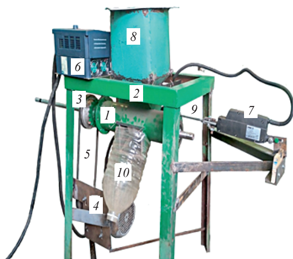
Рис. 1. Лабораторная установка для проведения исследований с экспериментальным дозатором: 1 – дозатор; 2 – рама; 3 – ротор; 4 – электродвигатель; 5 – приводной ремень; 6 – частотный преобразователь; 7 – актуатор; 8 – приемный бункер; 9 – поводок; 10 – выгрузной приемник-накопитель
