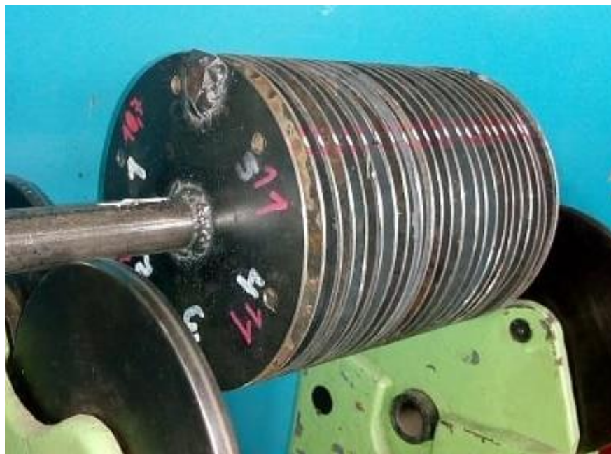
Рисунок 3.5 – Установка корректирующих масс
