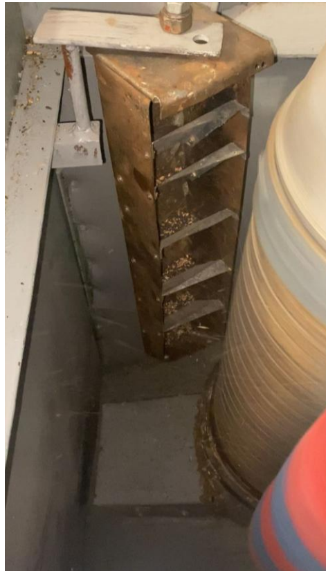
Рисунок 3.9 – Рабочий процесс центробежно-решетного сепаратора с подсевным решетом с шириной отверстия \Delta - 2,0 мм
