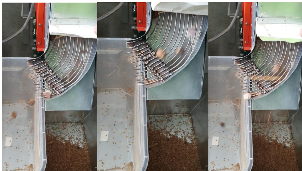
Рисунок 3.15 – Процесс отделения грубых примесей при работе гравитационного сепарирующего устройства
