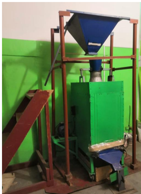
Рисунок 3.8 – Общий вид лабораторной установки центробежно-решетного сепаратора
