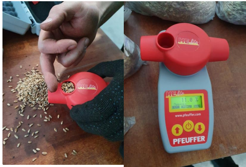
Рисунок 3.12 – Процесс измерения влажности зерна влагомером He-Lite «PFEUFFER»
