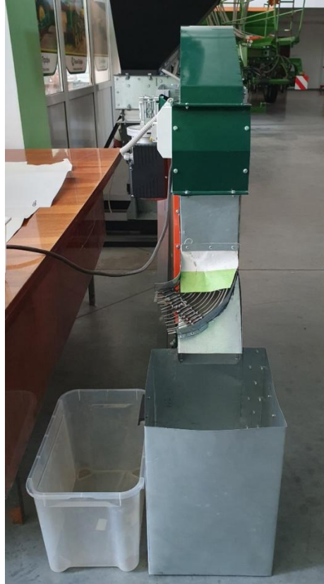
Рисунок 3.14 – Сепарирующий корпус камнеотборника с емкостями для зернового материала
