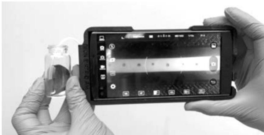
Рис. 1. Внешний вид прибора для диагностики болезней растений
