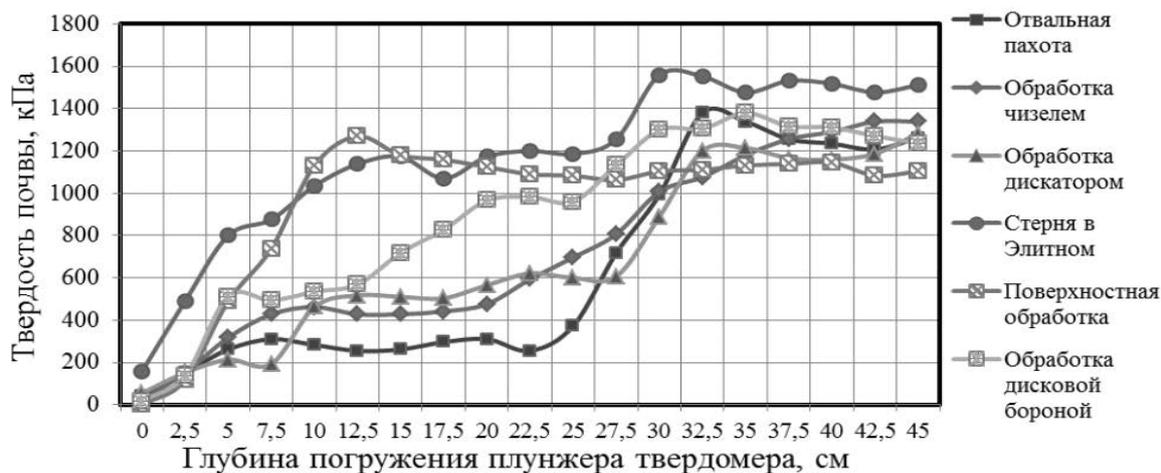
Рис. 2. Твердость почвы на полях СибНИИРС на 3 мая 2019 г. при различных видах обработки
