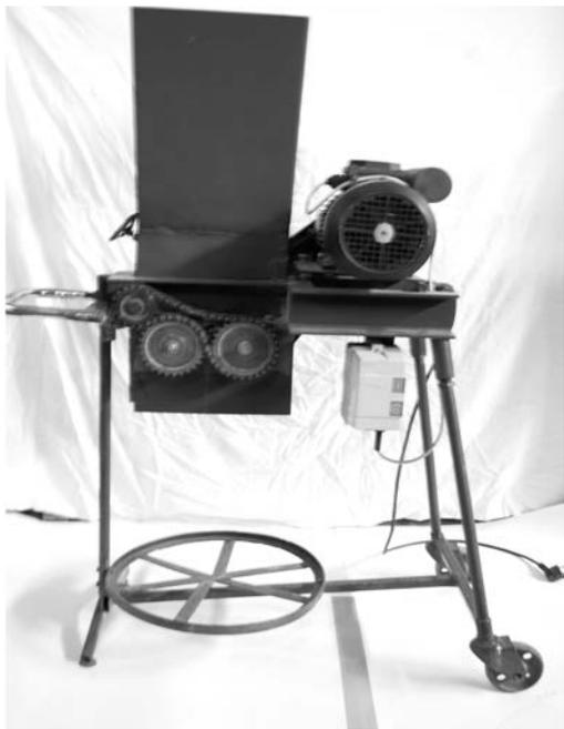
Рис. 2. Усовершенствованный агрегат АПЗ – 02 для плющения высоко влажного зерна (вид справа, с серийным лотком, ручкой, подставкой для бачка и двумя опорами с колесиками)
