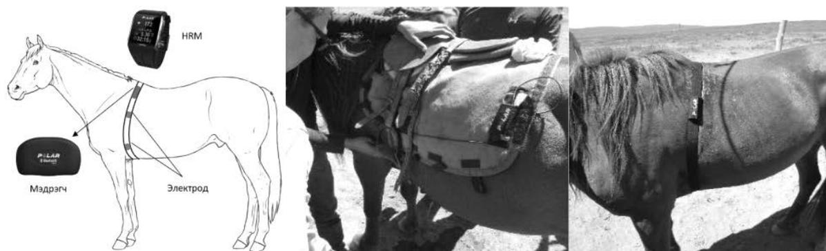
Рис. 1. Портативный инструмент измеряющий частоту сердечных сокращений и скорость (HRM)
