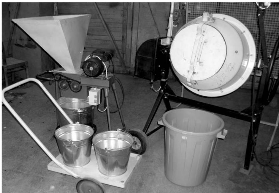
Рис. 3. Применение усовершенствованного агрегата АПЗ – 02 (слева) с прямоточным лотком в составе линии приготовления и раздачи биоактивированного зерна (с раздаточной тележкой, бачком для высоко влажного зерна и биоактиватором зерна)
