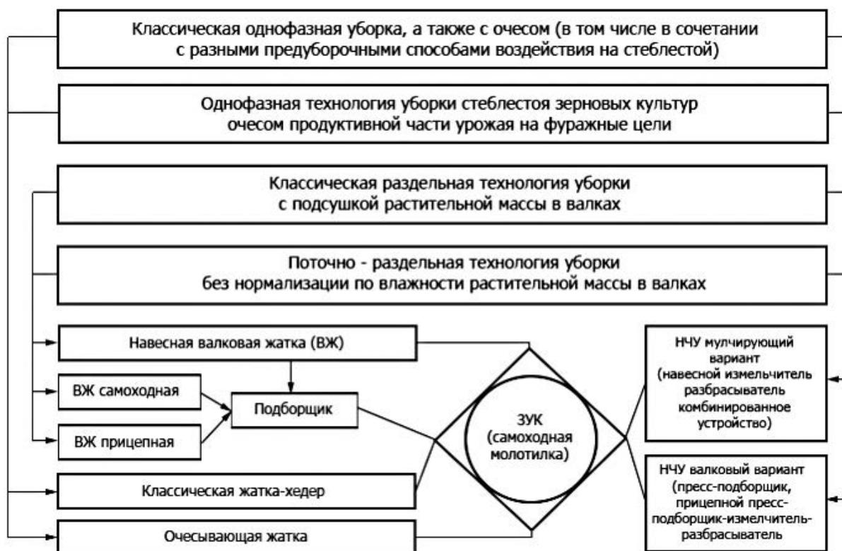
Рис. 1. Техническое обеспечение технологий уборки урожая зерновых культур
