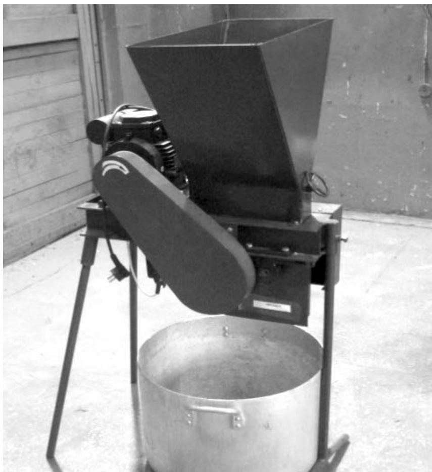
Рис. 1. Агрегат вальцовый для плющения зерна АПЗ – 02
