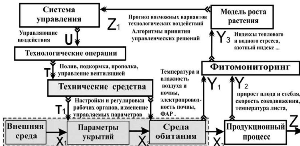
Рис. 2. Схема процесса получения, обработки и использования результатов измерений характеристик среды обитаний и параметров растений.
