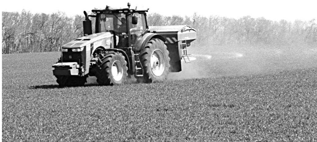
Рис. 1. Разбрасыватель минеральных удобрений ZA-TS при дифференцированном внесении – при подкормке озимой пшеницы
